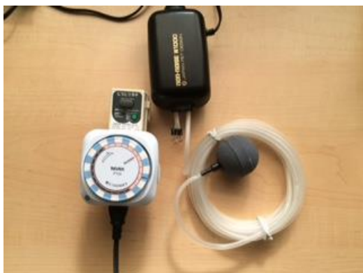
タイマー 漏電遮断器 エアレーション設備
