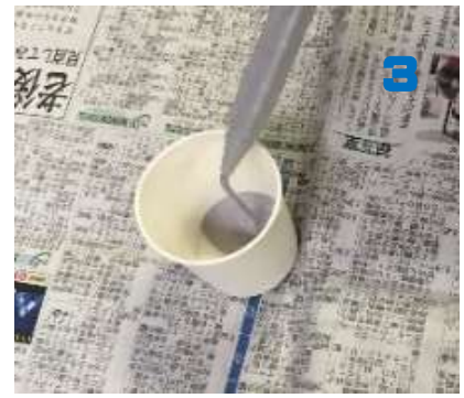
3 カートリッジをよく振り、材料が混合するまで約 10ml 廃棄します。
