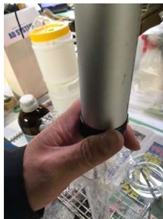
写真7 検知管にガス吸引
